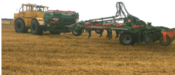
Рисунок 1 - Бункер XTender с культиватором Ceniус-TX для внутрипочвенного внесения удобрений
