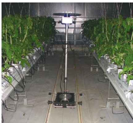
Рисунок 3 – Роботизированная установка для лазерного облучения вегетирующих растений овощных культур
