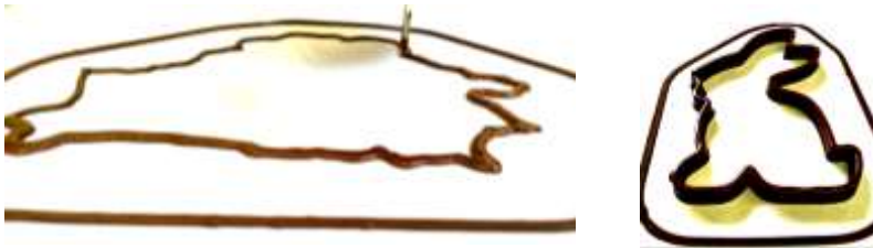
Рисунок – Внешний вид изделий, полученных методом 3D-печати на разработанном принтере
