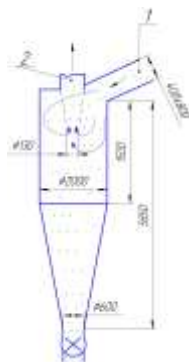
Рисунок – Схема работы и размеры циклона сушильной установки VRA-4
